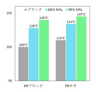
荷重たわみ温度(0.45 MPa)の変化
